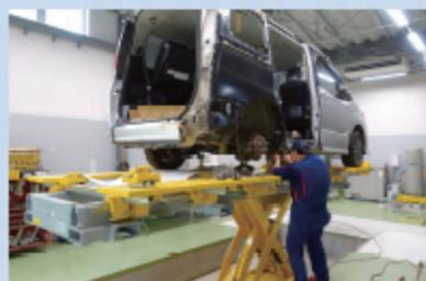
損傷した車両をミリ単位で計測できる三次元車体デジタル測定器や、正確なフレーム修正を行うジグ式フレーム修正機、タイヤの角度を調整し、車の基本である「走る・曲がる・止まる」の状態を復元するホイールアライメントテスターなど、車両修理に必要な最新鋭の設備を新たに導入。またそれらを取り扱う為の技術研修を実施し、計測データに基づいた精密な钣金修理を可能にしています。
